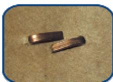
Die Heftung ist besonders stabil, da die Klammernschenkel auf der Pappentrückseite aneinander vorbeilaufen. Drei unterschiedliche Klammernlängen sind ohne Umstellung verwendbar.
